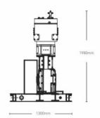
容积流量: 6m³/min、8m³/min 排气压力: 40Bar
