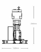
容积流量: 9m³/min、10m³/min、12m³/min、13m³/min 排气压力: 40Bar
