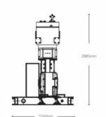
容积流量: 22m³/min、25m³/min、28m³/min、30m³/min 排气压力: 40Bar
